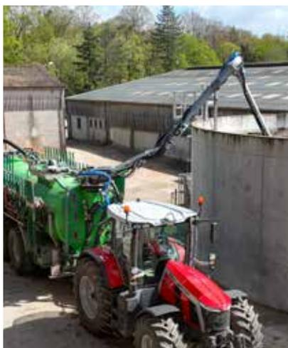
La ventaja de las flechas dorsales fijadas en la parte delantera es que proporcionan una **mejor visibilidad** al operador cuando las maneja. Puede alcanzar un ángulo de elevación máximo cuando se bombea a un contenedor o fosa sobre el suelo, y un ángulo de inmersión máximo cuando se bombea a una fosa subterránea.
